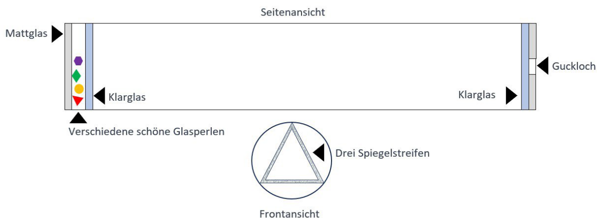
Abbildung 2.2-1: Funktionsweise des Kaleidoskops.
